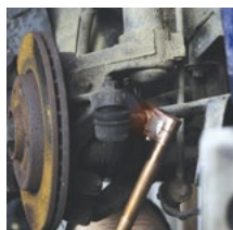
Sblocco dei braccetti
