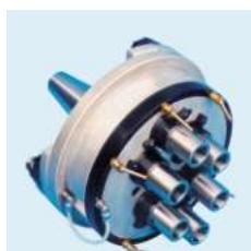
Testa a fusi multipli fissi o registrabili disponibile su richiesta. Multiple-Spindle Head Available on Request
