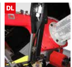
Dispositivo controllo deviazione lama Blade deflection control device
