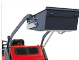
SISTEMA DI SCARICO CON PISTONE IDRAULICO.
